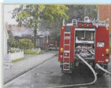
So sieht die Praxis aus: Direkter Zufluss vom Hydranten in den Tankfüllstützen des Löschfahrzeuges. Druckstöße können in diesem Fall nicht reguliert werden.
