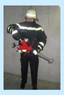
Aufdrehen eines Absperrventils. Das zweite Ventil wird geschlossen.
